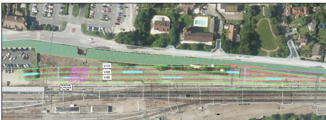
Figure 16 – 3 positions de garages créées voies 6, 8, et 10
